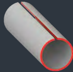
Brak deformacji powierzchni No crowning deformation
